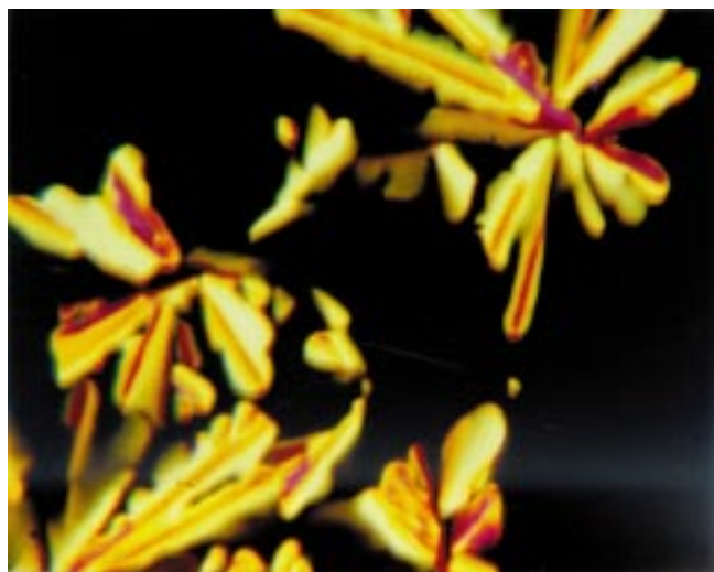
Abbildung 4. Beim Abkühlen einer 1:1-Mischung von 1 und 2 aus der isotropen Schmelze bei 90,8 °C beobachtete fächerförmige Textur (50fache Vergrößerung).
