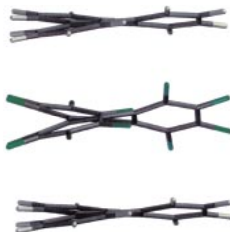
Abbildung 1. Struktur eines 1:1-Aggregats aus Perfluortriphenylen und Triphenylen im Kristall. Die Atomkoordinaten wurden röntgenstrukturanalytisch ermittelt. Der Abstand zwischen den Mittelpunkten der zentralen Ringe benachbarter Moleküle beträgt 3.698 \text{ \AA} . Der kürzeste intermolekulare C–C-Abstand beträgt 3.369 \text{ \AA} und der längste 4.029 \text{ \AA} .
